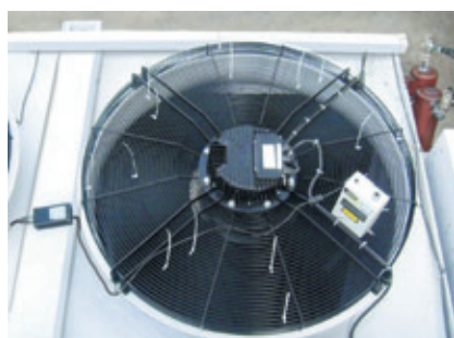
Fig. 6 Prove per verificare assenza trascinamento gocce. Tests to verify the absence of water droplet drag-out. Tests zum Nachweis von Tropfenaustritten. Test de vérification d'absence d'entraînement d'eau
